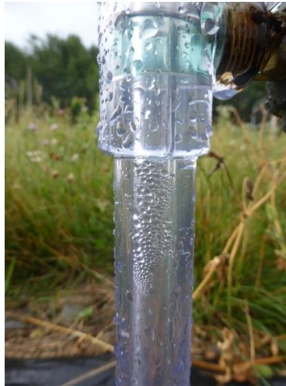
Figure 1. Tensiomètre vide
